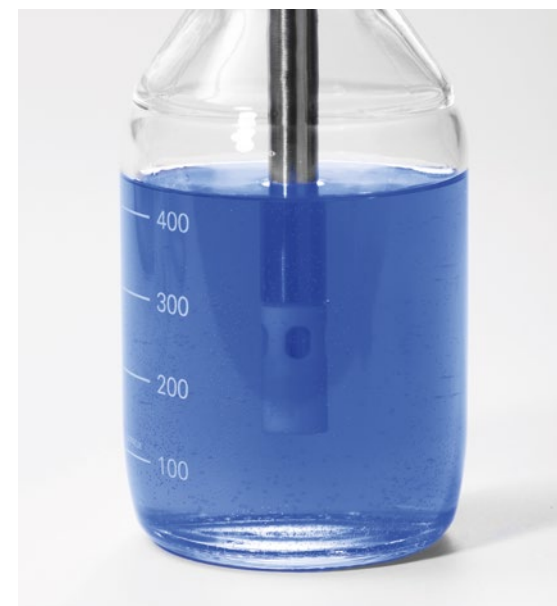
Abb. 4 Messung mit dem FLOWGUARD in einem Behälter
