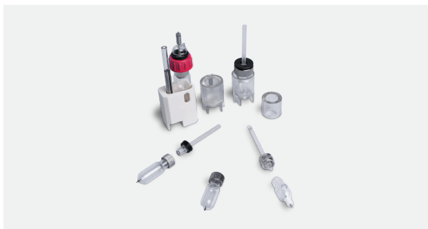
Különböző méretű dilatometerek pórusos anyag méréséhez
