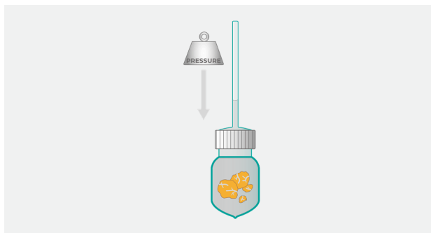
A „professional” dilatométer használata könnyű és biztonságos a csavaros fedél és a beépített nyitószerkezet révén.
