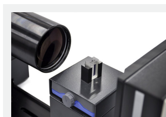
Pomiar na mokro przy użyciu celi wsadowej
