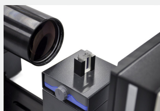
Mesure en voie humide moyennant une cuve en verre
